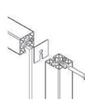
Dichtplatte 45 mit Schlitz
