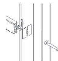
Dichtplatte 45 mit Doppelschlitz
